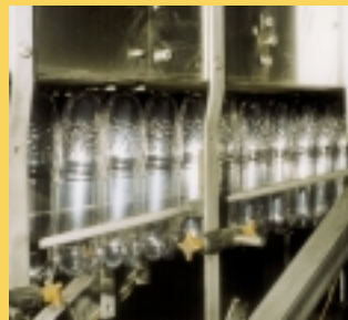
Die geformten PET-Flaschen werden der Abfüllung zugeführt
